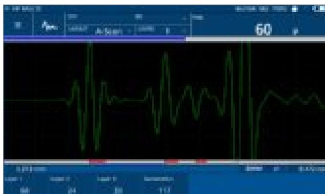
充满信心地对最多6层材料进行测量，检测屏幕上显示单个层的测量值
